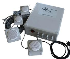
Les systèmes BR2 et CAO4 émettent des cris d'oiseaux (détresse et prédateurs) – sons hautes et basses fréquences – enregistrés sur un support externe (clé USB ou carte SD) inséré dans l'appareil, et diffusés par des HP modulables connectés chacun à 20 mètres de câble.
