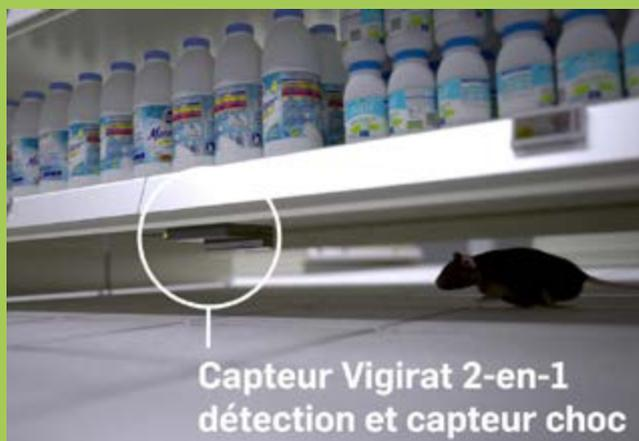
Les capteurs VIGIRAT sont des systèmes de monitoring nouvelle génération qui détectent la chaleur et le mouvement des rongeurs pour une surveillance claire et précise en temps réel. Les données sont transmises via réseau 4G ou LoRa puis exploitées sur un Dashboard et une application mobile dédiés.
